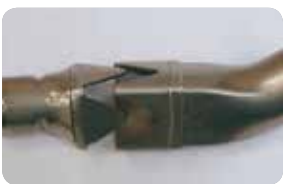
Konturschnitt Abgasanlage Contour cut of exhaust system
